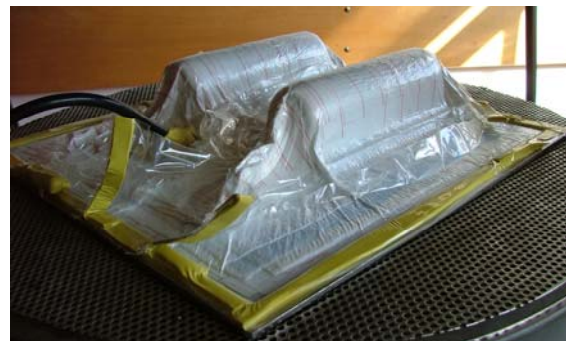
Figura 16 – Saco de vácuo com 2 EC, antes de iniciar a cura (vácuo já aplicado).
