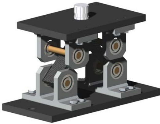
Figura 2 - Dispositivo de ensaio de vigas curvas segundo ASTM D6415
