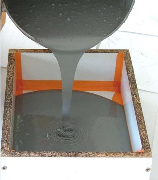
Obtenção do molde da viga curva, com resina maquinável Biresin VP HTR
