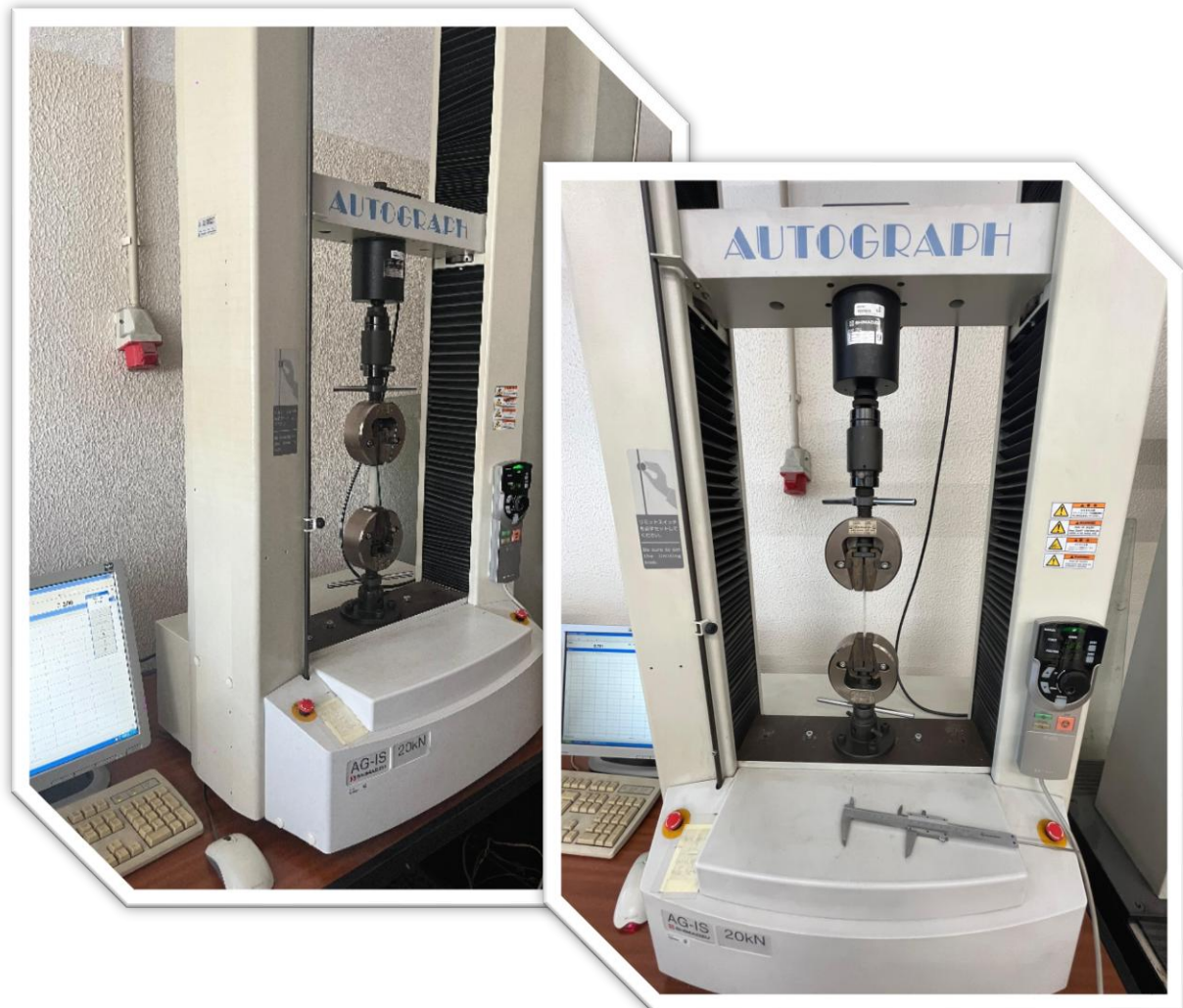
Figura 7: Máquina de tração Shimadzu AG-IS 20kN.
