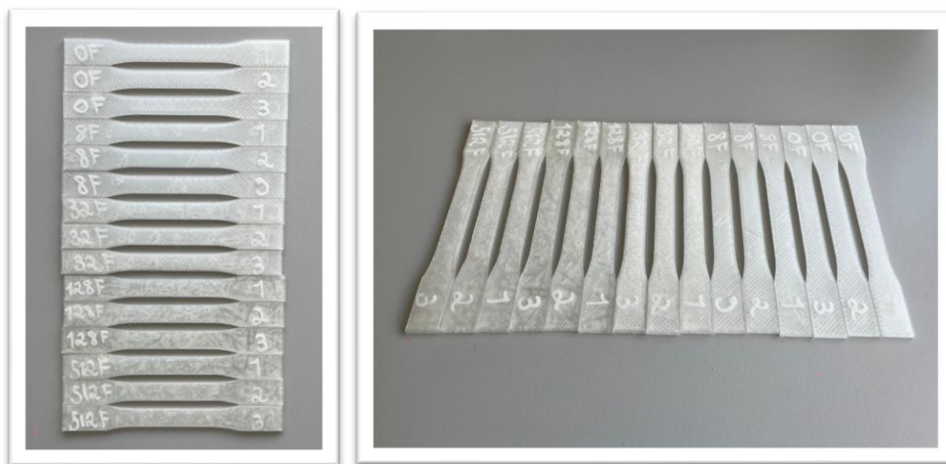
Figura 38: Provetes ordenados de 0 a 512 cavidades.
