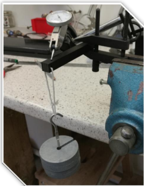
Figura 4: Ensaio de flexão montado.
